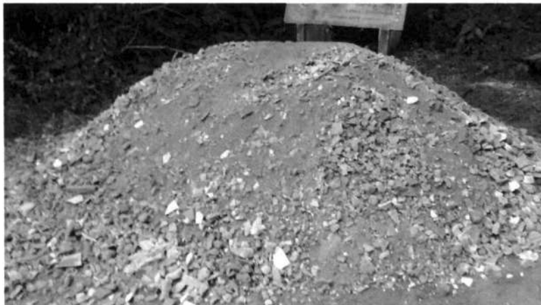
Foto 3 Resíduos Sólidos de Construção Utilizados Na Manutenção Da Estrada
