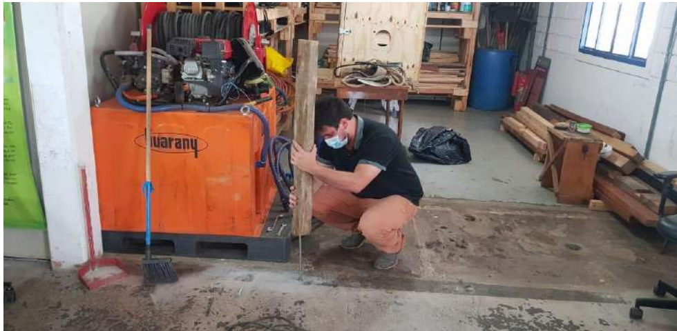
Figura 33 - Fixação do poste de 1 metro na barra roscada e no parabol
