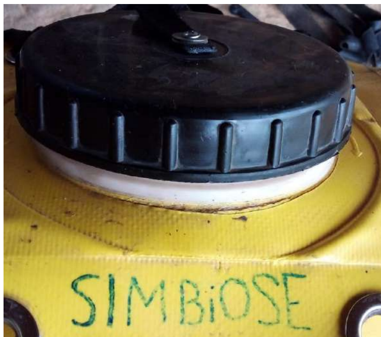
Figura 16 – Bomba costal que apresentou avaria no bocal de vedação, em setembro de 2021
