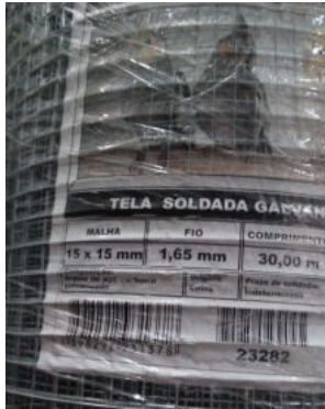
Telas para repor em locais dos viveiros onde a maresia já corroeu a tela
